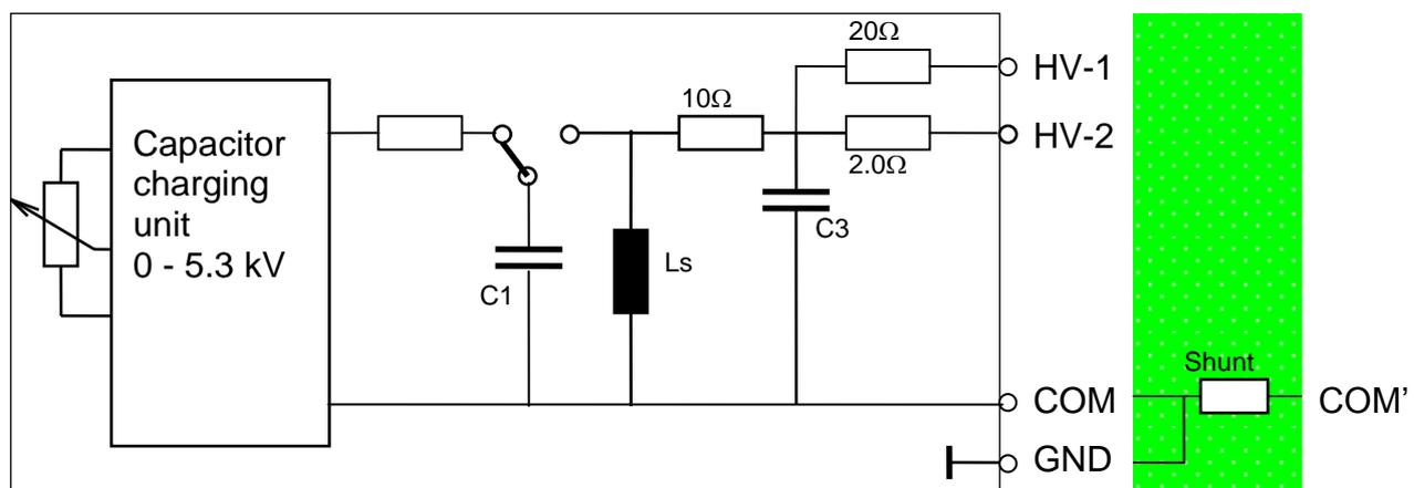
Fig. 1: Ring-Wave Generator IPG 612T, schematic
