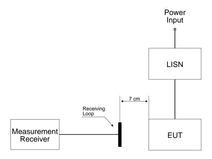
FIGURE RE101-4. Basic test setup.
