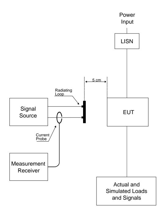
FIGURE RS101-4. Basic test setup
