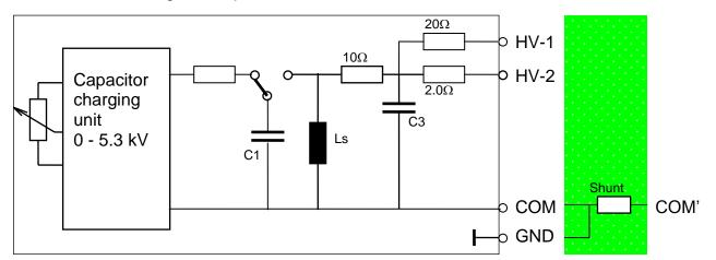
Fig. 1: Ring-Wave Generator IPG 612T, schematic
